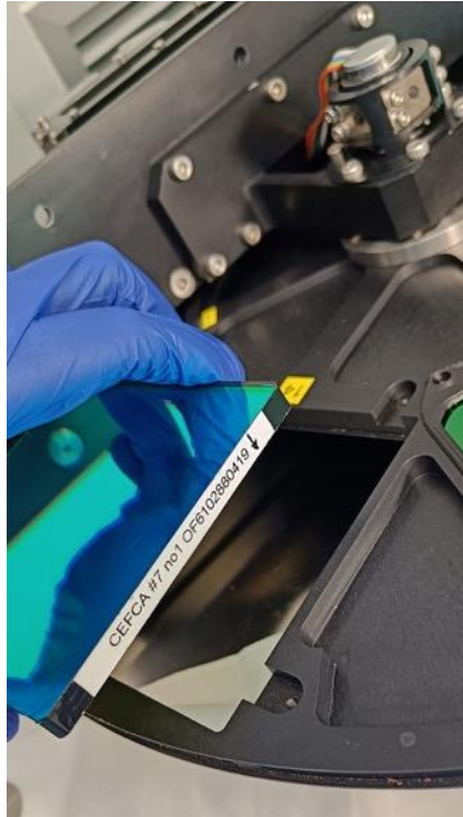
Imagen del filtro que ha permitido realizar el estudio, en el momento en que se coloca en una de las ruedas de filtros del instrumento científico del telescopio JAST80, la cámara T80Cam. /CEFC A
